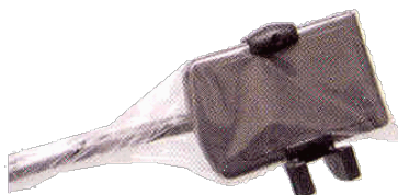
Obrázek 16: Použití ochranného pouzdra senzoru
